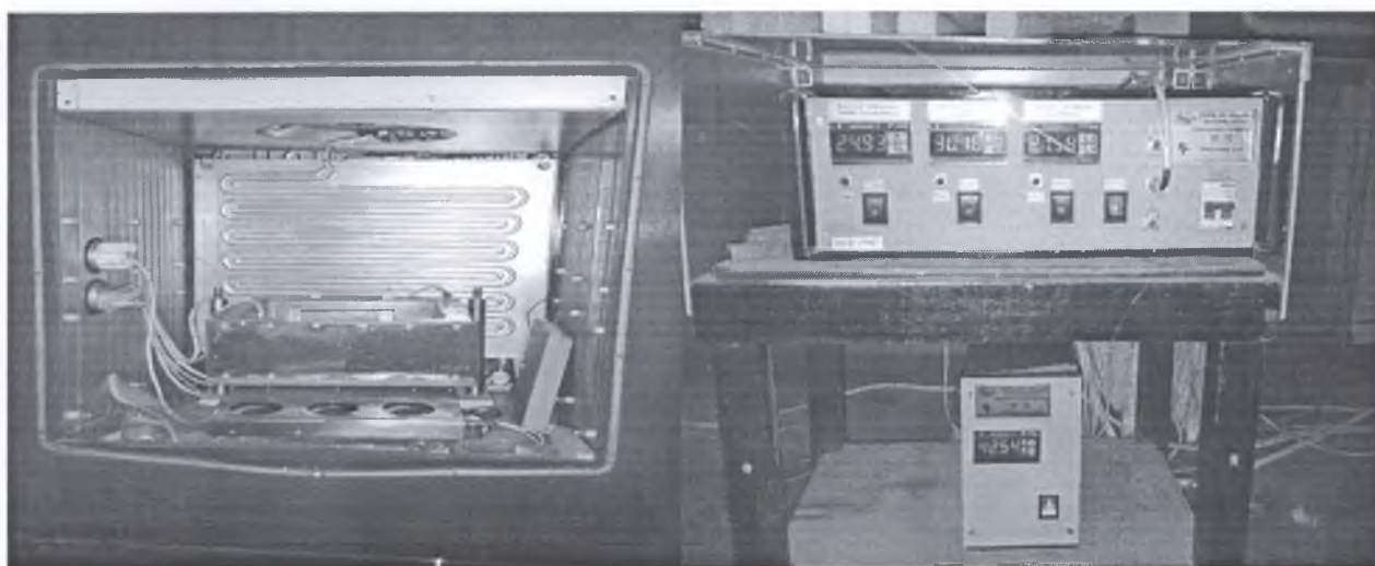
Рисунок 1 – Установка для визначення теплопровідності згідно з ДСТУ Б В.2.7-105-2000 (ГОСТ 7076-99)
